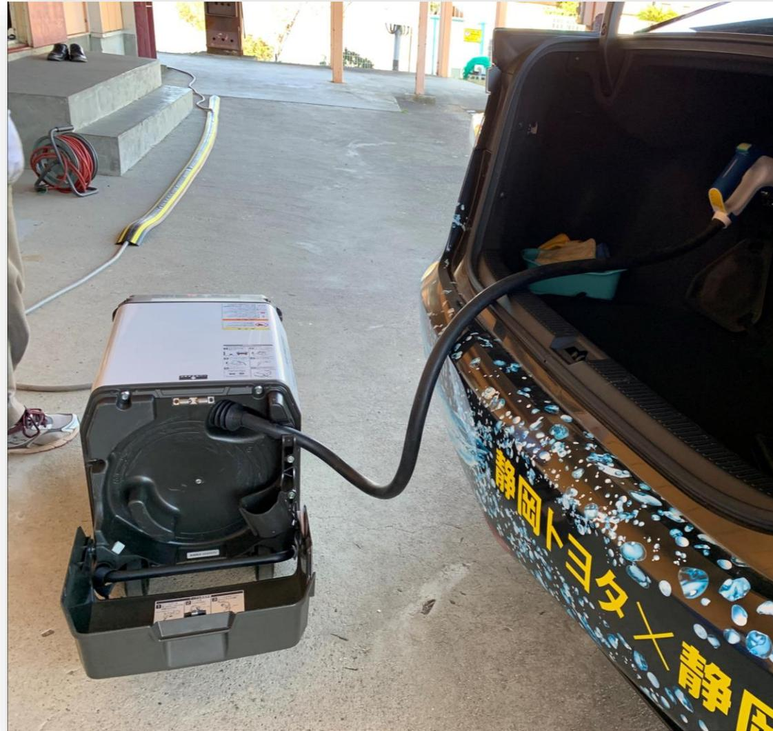
燃料電池車「MIRAI」に外部給電器
