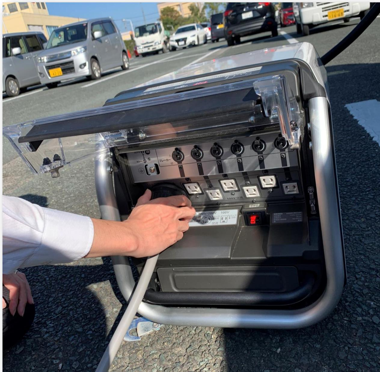
専用コンセントの反対側を外部給電器に接続
